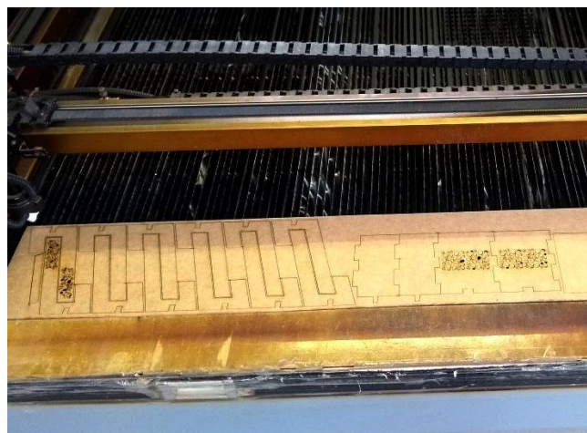
Figura 37 - Processo de corte a laser do MDF
