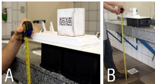
Figura 47 - Mesa com 1 m de altura, utilizada para realizar o ensaio de queda
